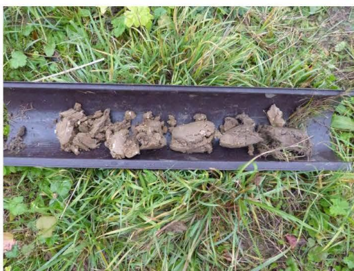
Figure 5 : profil de sol du sondage 1.
