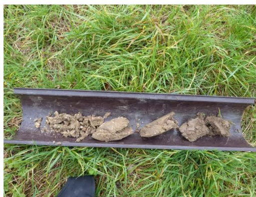
Figure 6 : profil de sol du sondage 2.
