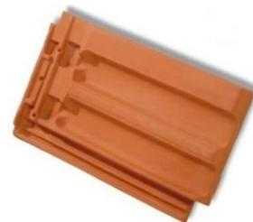
*Tuile mécanique à côte type H14, densité 13 à 14 unités au m<sup>2</sup>*
